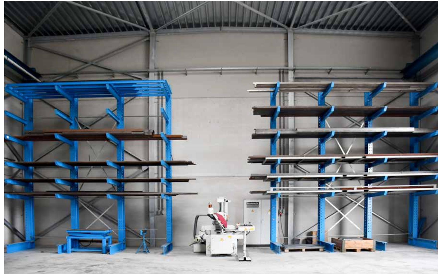
Met een bereik tot 520 mm diameter is de nieuwe Behringer zaagmachine een maatje groter dan zijn voorganger. Bovendien snijdt hij zowel profielen als vol materiaal perfect op maat.
